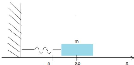
Fissiamo come asse  $x$  la retta lungo cui si sposta il corpo - supposto di massa  $m$  - e l'origine sia la posizione di equilibrio della molla. Supponiamo che all'istante  $t_0 = 0$  il corpo, spostato dall'origine di una quantità  $x$ , sia lasciato libero di muoversi. La forza elastica di richiamo (forza di Hooke) agisce proporzionalmente allo spostamento:  $F = -kx$   $k > 0$ .
